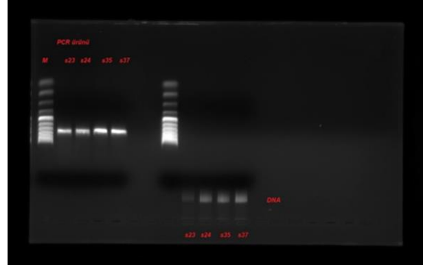
Şekil 2. PZR ürünleri ve DNA'ların SynGene GBox marka görüntüleme cihazında görünümü. M: Marker (100bp), s23, s24, s35, s37: Pozitif numuneler
