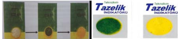
Şekil 3. İstenilmeyen sıcaklığa maruz kalındığında indikatörün renk değişimi (3).
