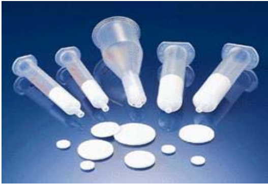
Şekil 2. c) Çeşitli ticari SPE kolon ve diskleri (14)
