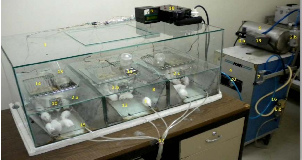
Şekil 1. KG modelinin görünümü. 1. KGK (Kuru göz kabini), 2.a.b.c. DHK (Deney hayvan kabinleri), 3. Denekler, 4. HK (Hava kompresörü), 5. HK tüpü, 6.a.b.c. Su separatörleri, 7. Debimetre, 8. Desikatör hazineleri, 9. FHT kontrol paneli, 10. Fan, 11. Nem-Sıcaklık ölçer, 12. Mobil cam plakalar, 13. Suluk, 14. Yemlik, 15. Hava giriş delikleri, 16. Pnömatik hortum, 17. Fleksibl inhalasyon hortumları, 18. Fan anahtar paneli, 19. HK basınç paneli, 20. HK basınç göstergesi.
