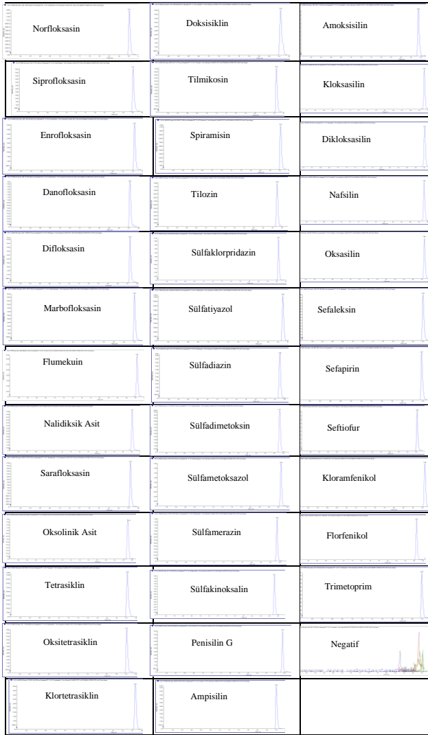
Şekil 1. Seçilen 37 antibiyotik için standart solüsyonların kromatogramları ile negatif pik
